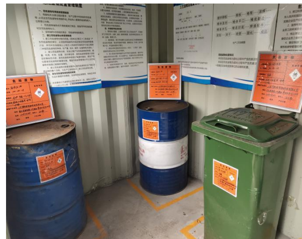
2-24 危废暂存库分区存放
